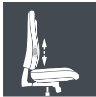
Rückenlehne mit höhenverstellbarer Lordosenstütze
