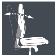
Mécanisme contact permanent
